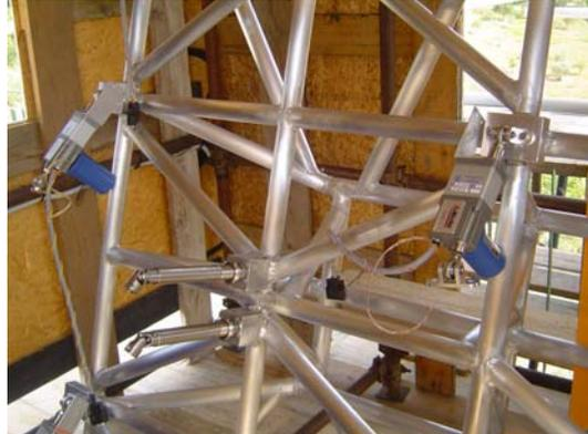
Sul carrello sono montati anche i dispositivi elettromeccanici per il controllo di tutti i motori. L'alimentazione ed i segnali di controllo giungono tramite cavi, contenuti in una catena portacavi, situata appena fuori dalle rotaie, sul lato interno.
