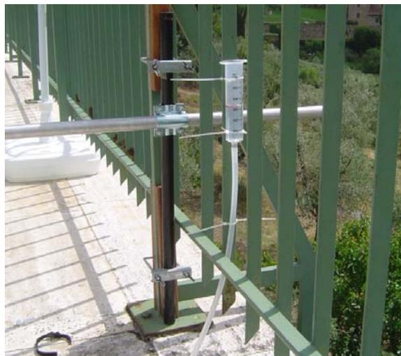
livella ad acqua, per assicurare la planarità del binario. Con i bulloni di regolazione dei piedi la traversina è stata regolata in altezza. In questo modo l'errore sulla planarità si mantiene ad un millimetro su tutta la rotaia, mentre con una livella a bolla (o una livella laser, basata su una bolla), la propagazione degli errori porta almeno ad un centimetro di indeterminazione. La figura seguente mostra la rotaia montata.
