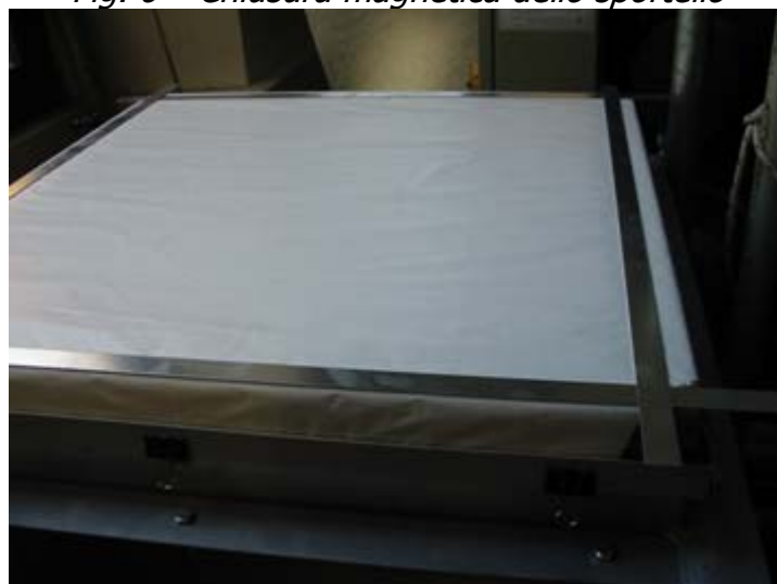
Fig. 7 – Sistema di tensionamento dell'Astrosolar
