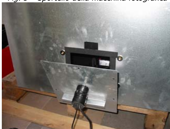
Fig. 6 – Chiusura magnetica dello sportello
