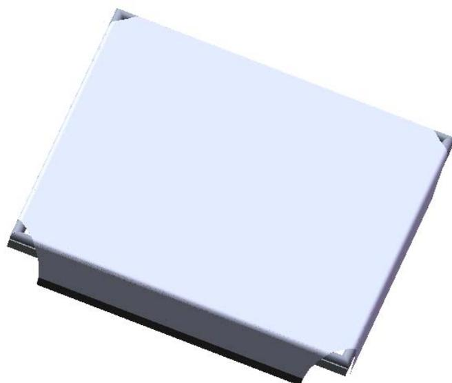
Fig. 15 – Camera oscura: telaio per filtro ottico.
